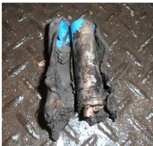
発煙（小火）の原因となった電池類
