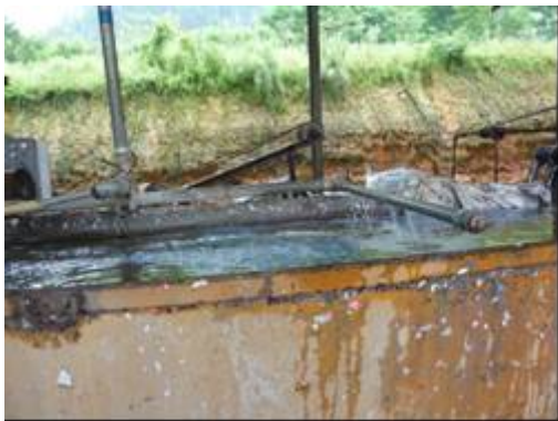
再生 PET 繊維工場・原料処理からの一貫体制⑨2次洗浄・比重分離工程
