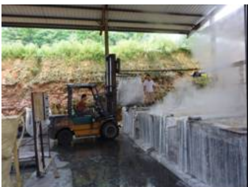
再生 PET 繊維工場・原料処理からの一貫体制⑪フレーク調達品も再洗浄する。この際、最終洗浄品と一緒にする場合もある。
