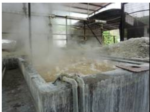
再生 PET 繊維工場・原料処理からの一貫体制⑫購入フレークや最終洗浄品も再度洗浄すると水はなおかなり汚れる。写真右は、完成フレーク。
