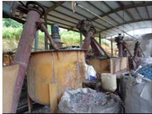
再生 PET 繊維工場・原料処理からの一貫体制⑧1次洗浄品は2次洗浄・比重分離工程へ送られる。
