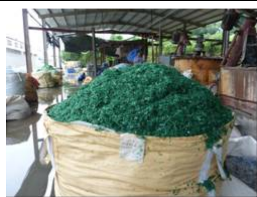
再生 PET 繊維工場・原料処理からの一貫体制⑮完成フレーク（写真はカラーフレーク）。
