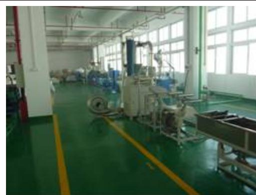
同加工基地④廃 PET 再生処理工場（ペレタイズ工程）PET 以外でも使用。
