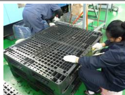
同加工基地⑥HDPE 再生ペレットで生産されたパレット（バリ取り作業）
