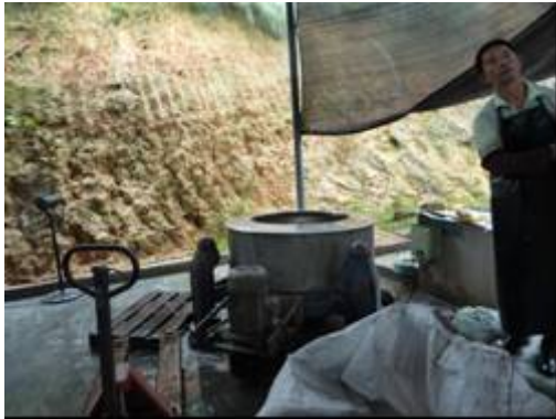
再生 PET 繊維工場・原料処理からの一貫体制⑬脱水機にかけた後、一旦、袋詰めして保管される。
