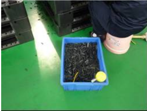
同加工基地⑦パレットの成型ロス（バリ）は同工場内で再使用される。
