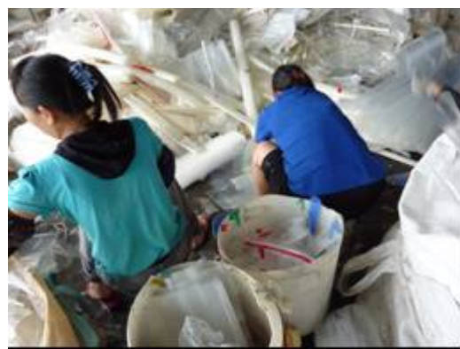
再生 PET 繊維工場・原料処理からの一貫体制⑤フィルムの前処理（色やシールのついた部分のカット作業）
