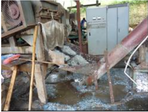
再生 PET 繊維工場・原料処理からの一貫体制⑦1次洗浄・比重分離後のフレーク。
