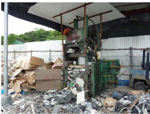
香港：圧縮機。分離したプラスチック部位をサイコロプレスにする。
