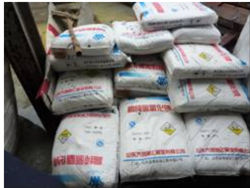
再生 PET 繊維工場・原料処理からの一貫体制⑭汚れの酷いペールもあるため、浄工程では苛性ソーダが使用される。
