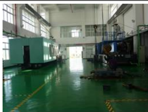
同加工基地⑤HDPE 製プラスチックパレットの生産ライン
