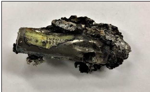
発火原因となったリチウムイオン電池
