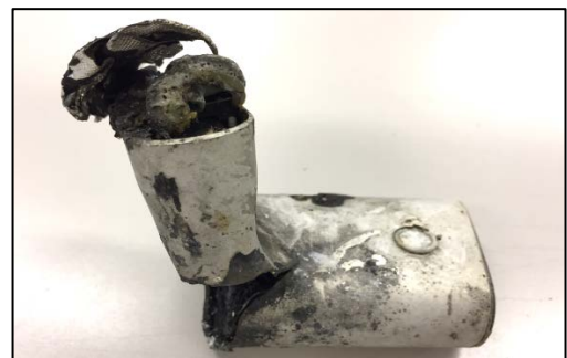
発火原因となった電子タバコ(リチウムイオン電池内蔵)
