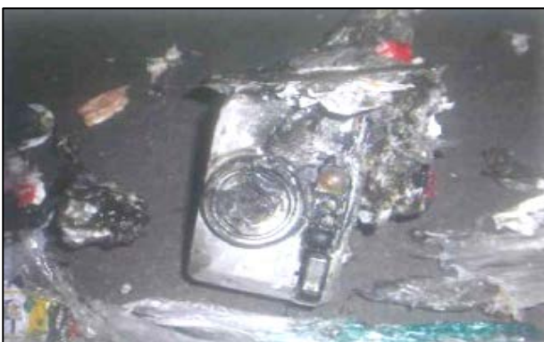
発火原因となったデジタルカメラ(リチウムイオン電池内蔵)
