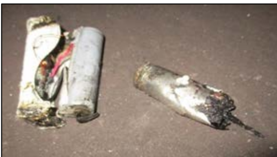
発火原因となったリチウムイオン電池
