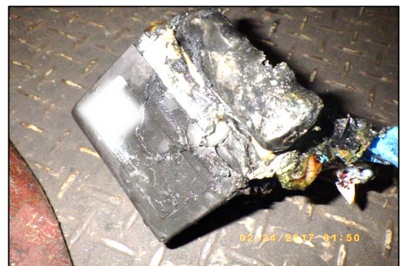
発火原因となった掃除機(リチウムイオン電池内蔵)
