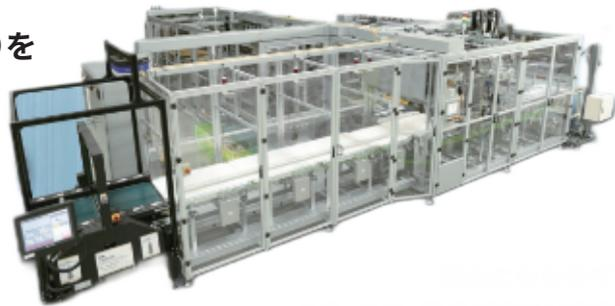
商品サイズを計測しそのサイズに合わせてシートを加工、そこに商品を載せて箱を成形し、最後に蓋をかぶせてラベル貼りまでのすべてを自動で処理します。
