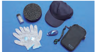
ケミカル／マテリアルリサイクルともに推進。ポリエステルはアスファルト資材や軍手、ナイロンはポーチや文具など多様に再生できます。
