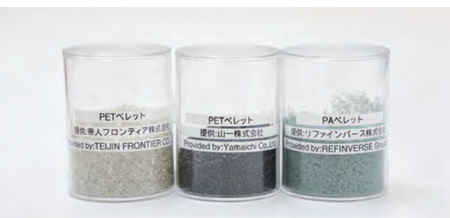
(左) 木下製網(株)のポリエステル製漁網は細く結び目のない「無結節網」が特徴。強度があるだけでなく、原料を30%削減できます。(上) 漁網から再生されたベレット。
