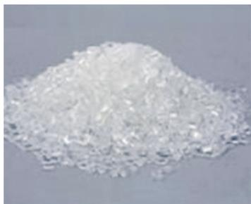
され得る状態にすることを指します。写真は、使用済みPETボトルからつくられたフレークとペレットと呼ばれる「再商品化製品」です。
