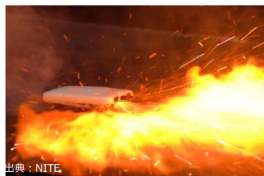
モバイルバッテリーの発火（再現実験）
