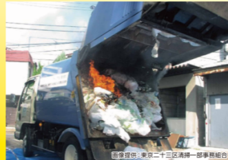
分別されずに出された充電式電池 から出火した写真
