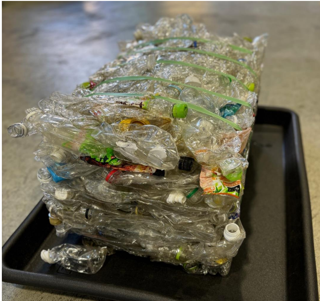
ペットボトル成型ベール（小型） 430W×350H×640L
