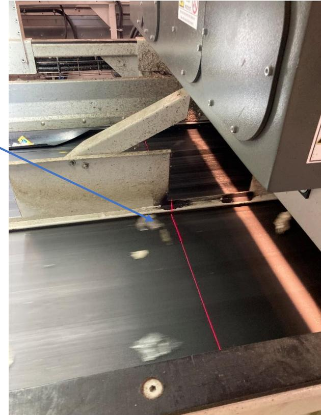
レーザー、AIカメラ、NIRの併用により選別精度を上げる
