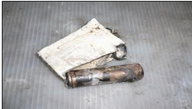
消火後のリチウムイオン電池（11/13火災事故のものではない）
